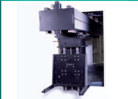
Gabelgreifer für 300 kg Handhabungsgewichte | Fork gripper for 300 kg handling weights
