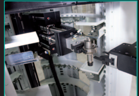
Parallelgreifer zur Handhabung von Werkzeughaltern, z.B. HSK | Parallel gripper for handling tool holders, e.g. HSK
