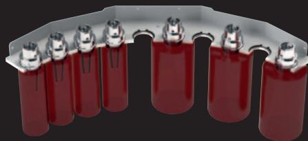
HSK 63 - Werkzeuggröße bis \varnothing 80 mm jeder Platz belegbar Werkzeuggröße bis \varnothing 130 mm jeder zweite Platz belegbar HSK 63 - Tool size up to \varnothing 80 mm respectively up to \varnothing 130 mm with free adjoining place
