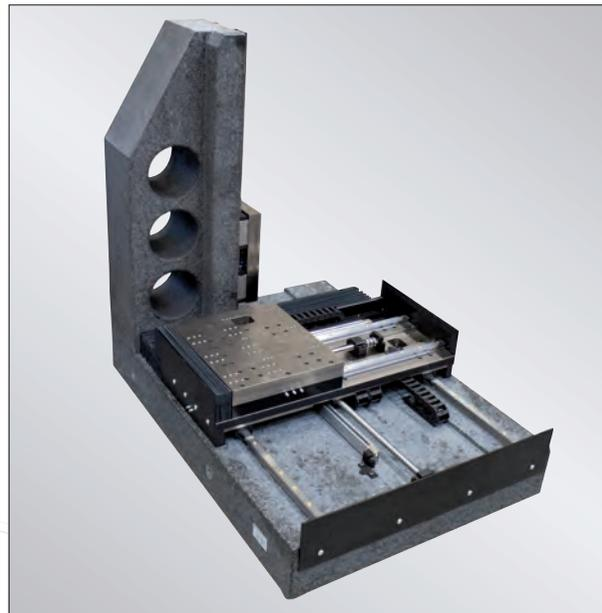
3-Achssystem für Lasermaschine
